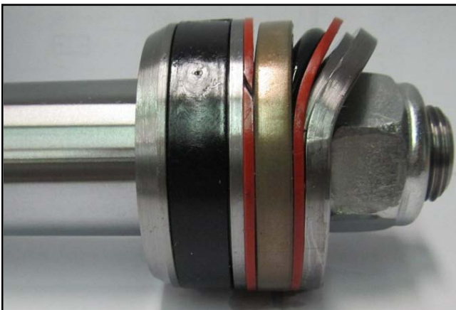
Slika 12. Zlom bata na testiranem HV pri tlaku 600 bar
