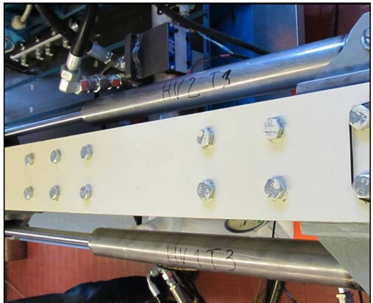
Slika 6. Fotografija preizkuševališča za izvedbo tlačnovzdržljivostnega testa z vzporedno testiranimi dvema hidravličnima valjema pri tlaku 353 bar, temperaturi hidravlične kapljevine 30 °C in fiksirani batnici 20 mm pred popolnoma izvlečenim stanjem
