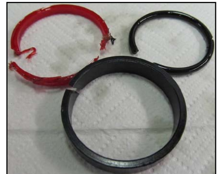
Slika 9. Izrabljeno in pretrgano poliuretansko tesnilo bata, drsni obroč brez deformacij že po 12 km opravljene poti (konfiguracija št. 1)
