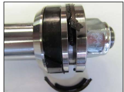
Slika 10. Strgano in izrabljeno poli-tetrafluor-etilensko tesnilo na batu testiranega HV po demontaži, po 37,4 km opravljene poti (konfiguracija št. 3)
