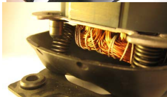
Slika 7: Kompresor z napako C3, ki kompresorsko grupo potiska naprej proti sprednji strani ohišja
