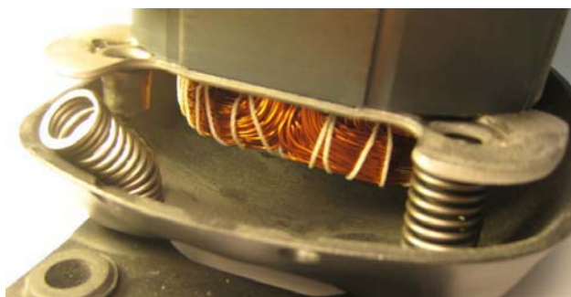
Slika 8: Kompresor z napako C2, ki kompresorsko grupo potiska proti zadnji strani ohišja
