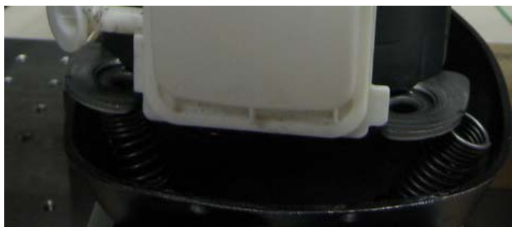
Slika 9: Kompresor z napako B1, ki kompresorsko grupo potiska vstran
