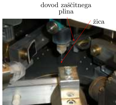
Slika 3.4: Prikaz dovoda zaščitnega plina
