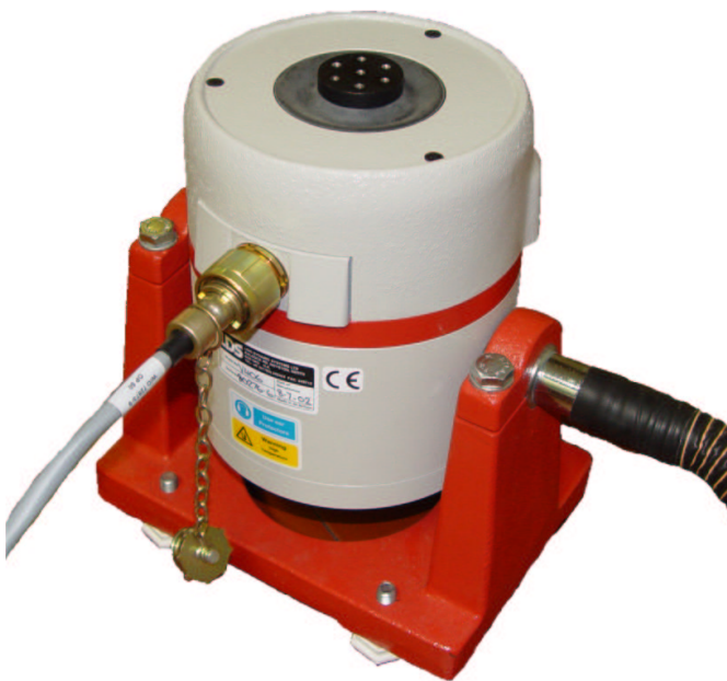
Abbildung 4: Der Montagekopf auf dem Shakeranker LDS V406.
