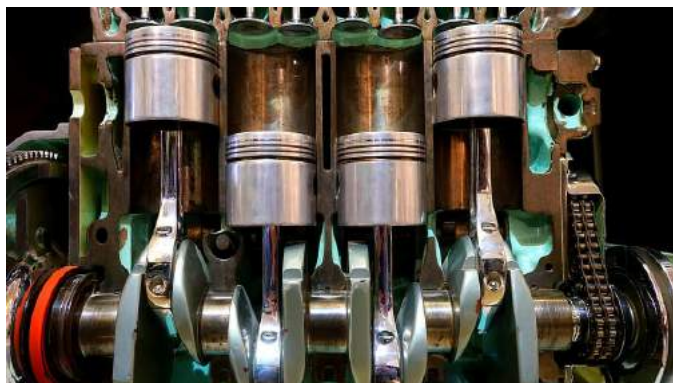
Slika 4: Ročni mehanizmi v avtomobilskem motorju.
